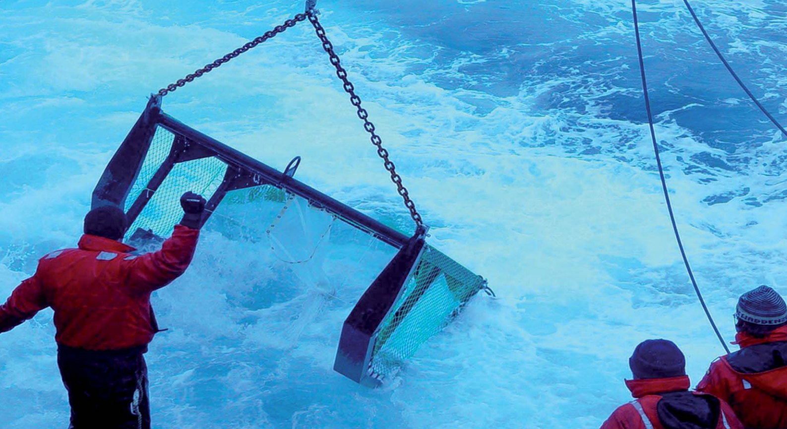
Tomando muestras de sedimentos con la draga de fondo (Archivo Hesperides).
